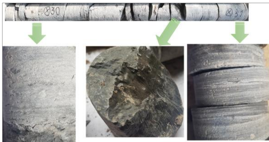
Рис. 3. Фото литолого-петрографической характеристики отложений аргиллит-алеврито-песчаного литотипа
