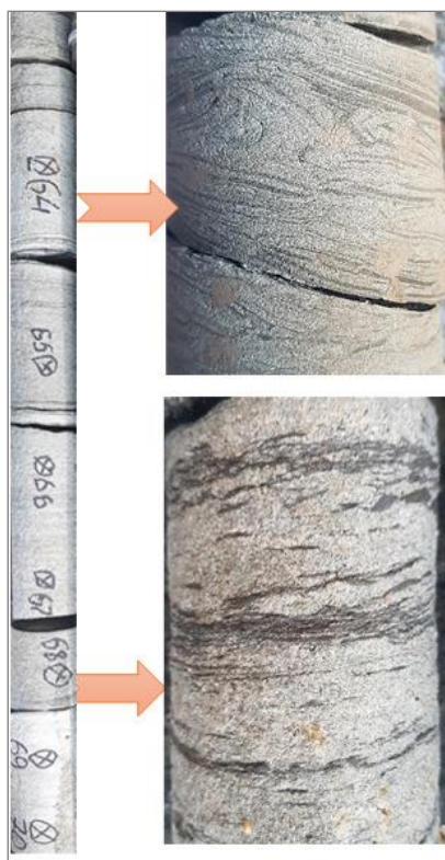
Рис. 5. Фото литолого-петрографической характеристики отложений песчаного литотипа
