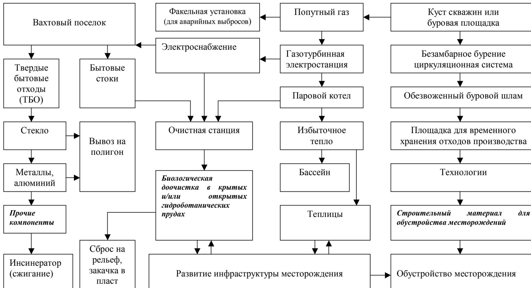
Рис. 2. Типовая схема утилизации попутного газа, отходов производства и потребления на средних и мелких месторождениях нефти
