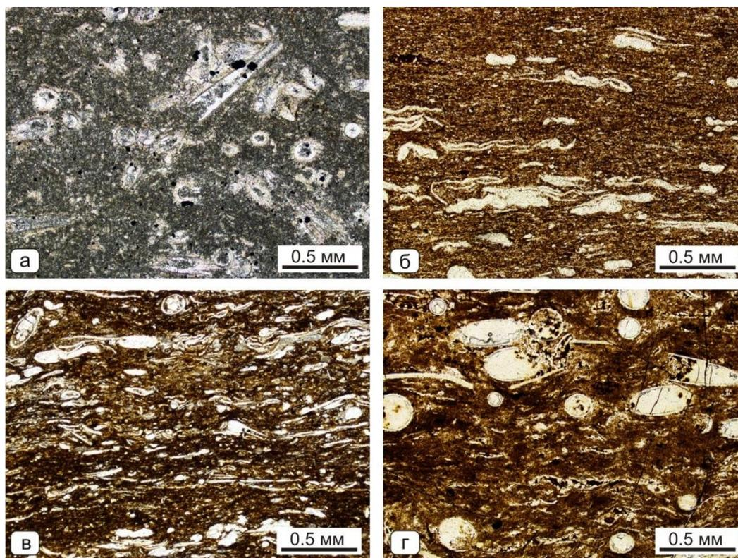
**Рис. 2. Микрофотографии основных типов пород, слагающих разрез доманиковых отложений**
