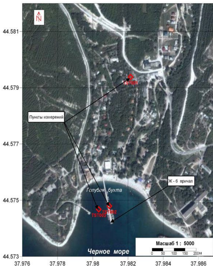
Рис. 5. Карта-снимок с точками испытаний донной станции МАРСС на берегу и на морском шельфе Черного моря
