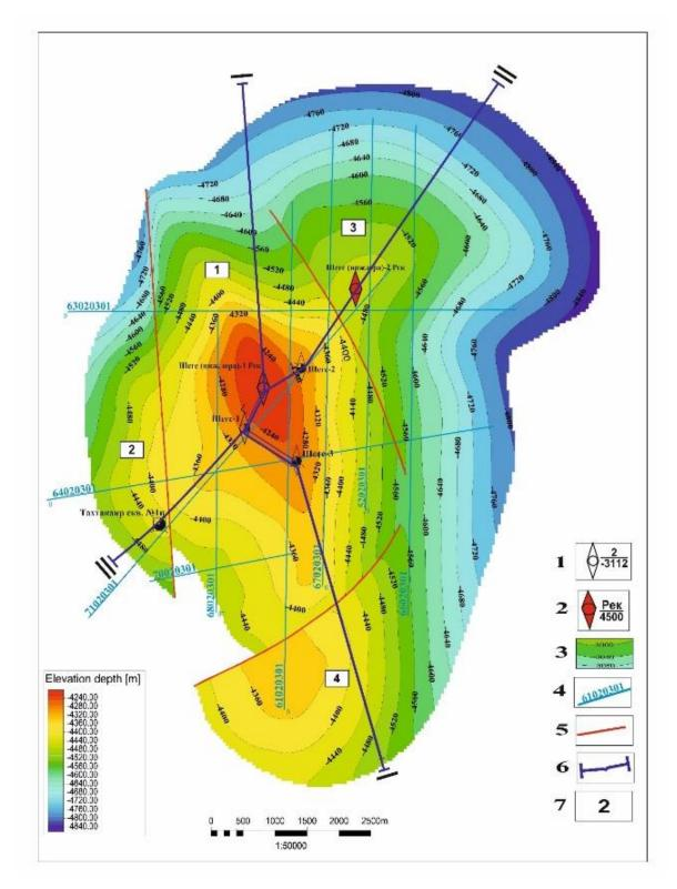
Рис. 5. Схематическая структурная карта по кровле базальных песчаников Куанышского горизонта месторождения Шеге (составил А.П. Абзалов, 2021 г.)
