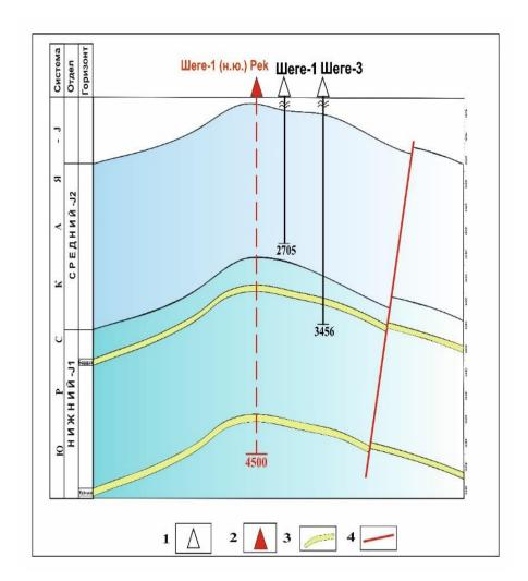
Рис. 2. Геологический профиль по линии I-I месторождения Шеге (составил А.П. Абзалов, 2021 г.)
