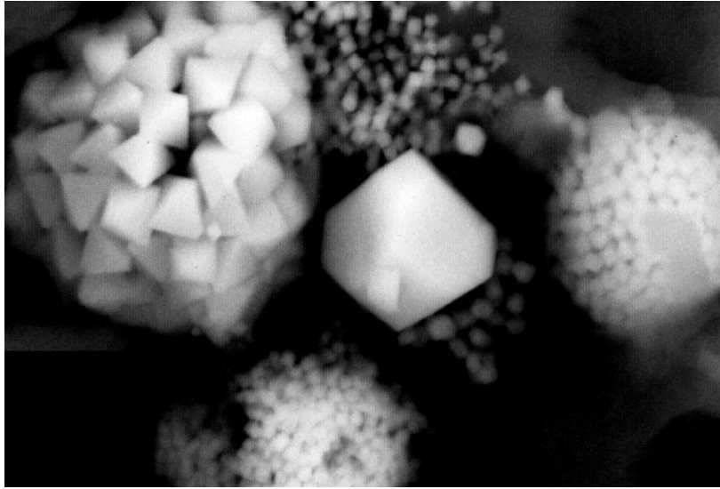
Рис. 10 Юльевское месторождение (скв. 1, 3507-3517 м). Формы пиритизации на контакте базального песчаника (продуктивный горизонт К-19) с фундаментом. СЭМ, ув. 6000 (по А.Е. Лукину)
