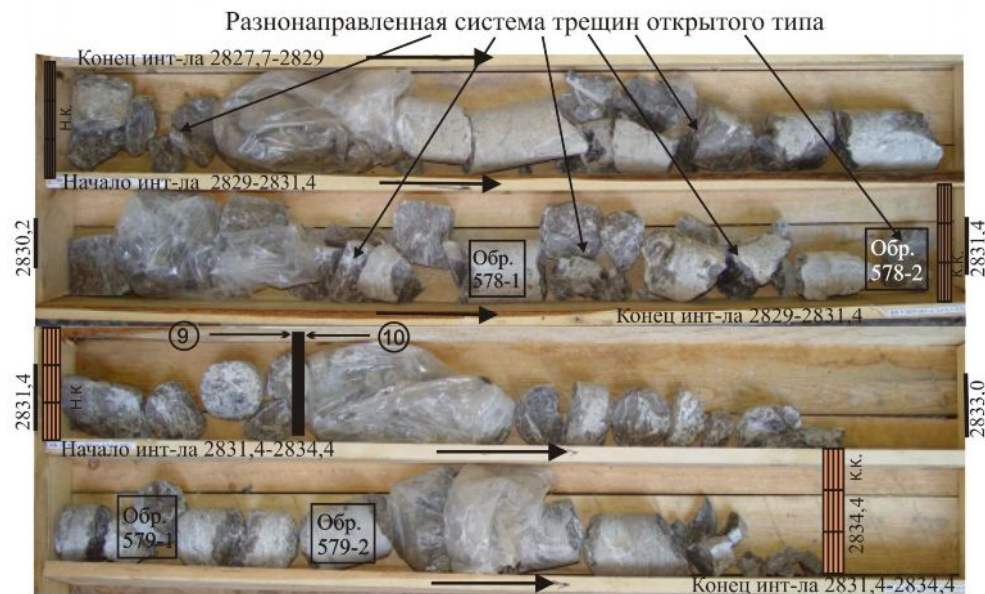
Верхняя часть трещинного резервуара со свободным пустотным пространством
