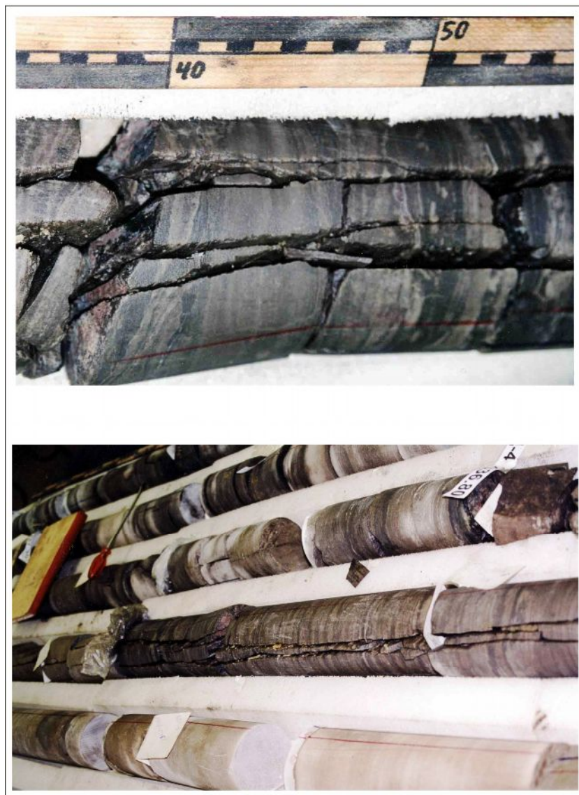
Рис. 5. Примеры трещиноватости в керне скважины Юр-89
