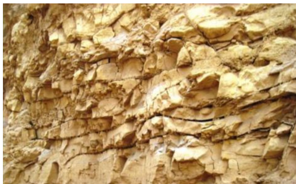
Рис. 1. Глинистый известняк, разбитый субгоризонтальными и субвертикальными трещинами на разномасштабные блоки, Египет, плато Гиза (фото А.М. Тюрина)
